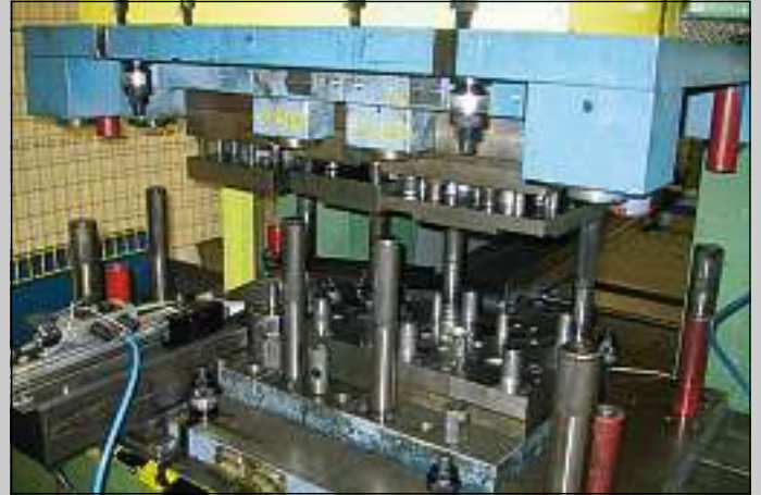
MC4-10 används i presslid och pressbord MC4-10 used for press ram and press table MC4-10 anwendbar für Stößel und Pressentisch
