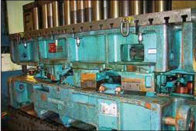
MC10 spänner ett 50 tons verktyg MC10 clamping a 50 ton die MC10 spannen ein 50 t schweres Werkzeug
