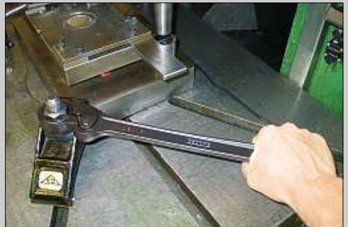
Åtdragning sker enkelt med spärrnyckel Easy clamping with ratchet wrench Schnelles Festspannen mit Spannschlüssel
