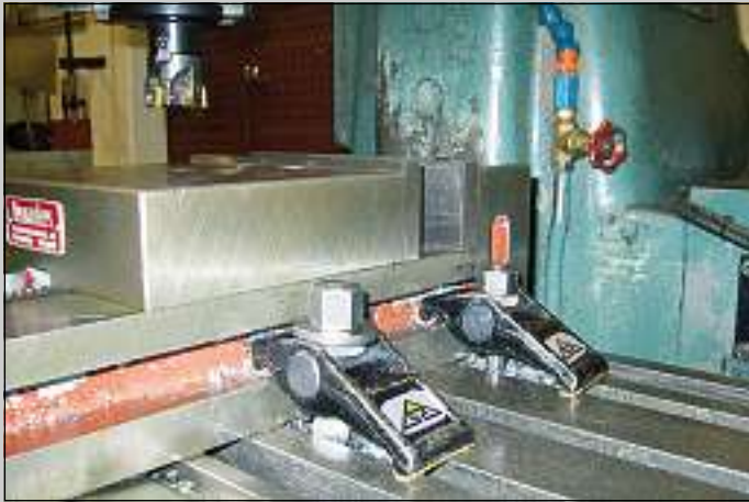
Fastspänning av arbetsstycke i fräs Clamping of work piece in a mill Bearbeitung eines Arbeitsstückes in einer Fräse
